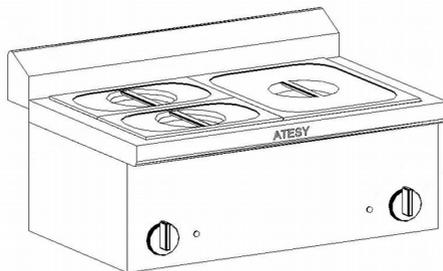
Модуль мармит предназначен для поддержания в горячем состоянии любых продуктов питания и готовых блюд, хранение которых возможно в стандартных гастроемкостях GN 1/2 и GN 1/4. Регулятор температуры мармита позволяет устанавливать температуру в пределах 30÷80°C.
